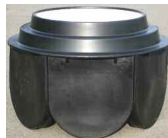
Рис. 4. Лоток для шахтной трубы диаметром (De) 1000-1200 мм, позволяет присоединение к колодцу трубопроводов диаметром 250, 315, 400, 500 мм.
