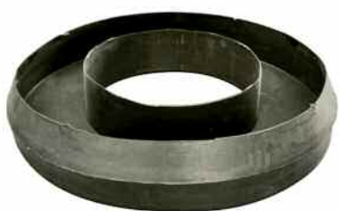
Фото 20. Форма для бетонирования.
