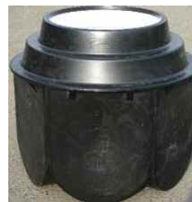
Рис. 3. Лоток для шахтной трубы диаметром (De) 630-800 мм, позволяет присоединение к колодцу трубопроводов диаметром 160, 200, 250, 315, 400 мм.
